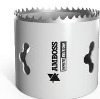
Lochsägen aus M42 Bimetall mit 8% Kobalt Anteil sind das Multitalent unter den Lochsägen. Holz und Holzwerkstoffe, Bleche und Edelstahl, Trockenbau, Kunststoffe und vieles mehr. Mit einer Schnitt-Tiefe von bis zu 48 mm, speziell designten Quick-Eject-Slots (Drei-Punkte-Auswurfschlitz für die schnelle Entfernung von Bohrkernen) sowie optimierter Zahngeometrie sind Sie als Anwender mit diesen Lochsägen für die meisten Fälle ausgestattet.
